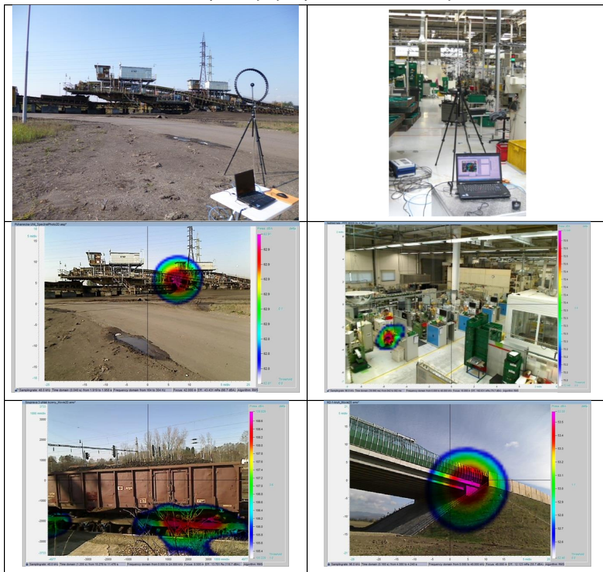
Obr. 3 Akustická kamera a příklady výstupu z akustické kamery - vizualizace zvuku
