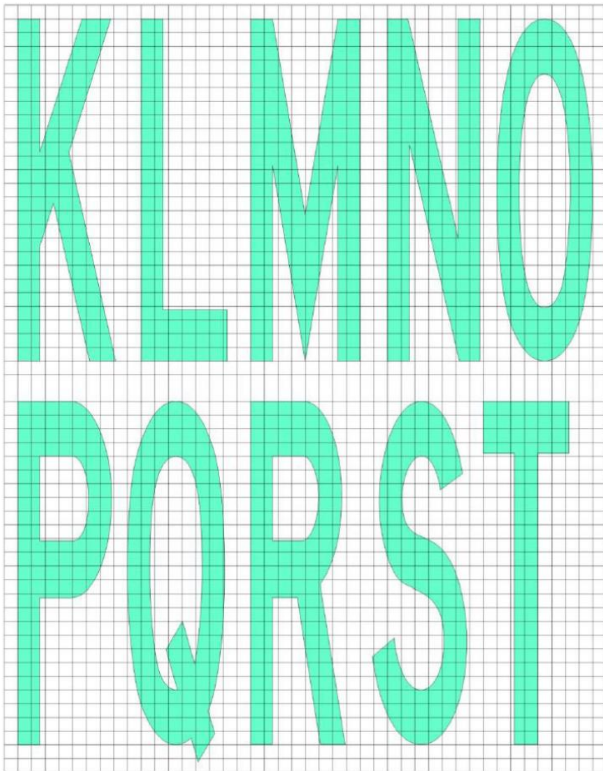
Obrázek L-10B. Tvar a rozměry nápisů příkazového značení
