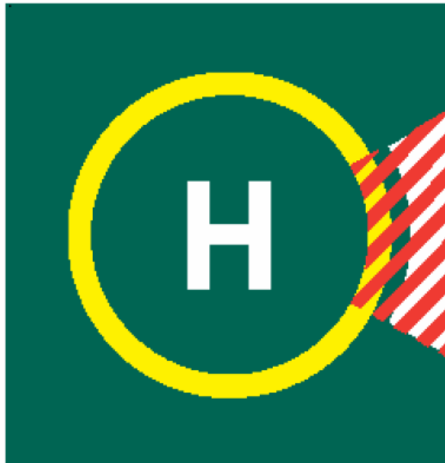
Obr. 5 - 7 Značení sektoru helideku se zákazem přistání
