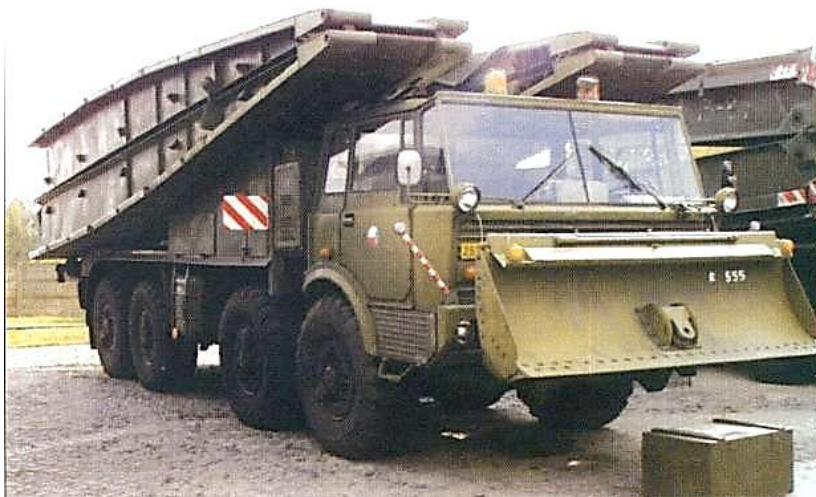
Obr. č. 2.6 Převravník mostu PM-55A
