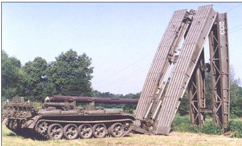
Obr. č. 2.5 Pokládka MT-55A
