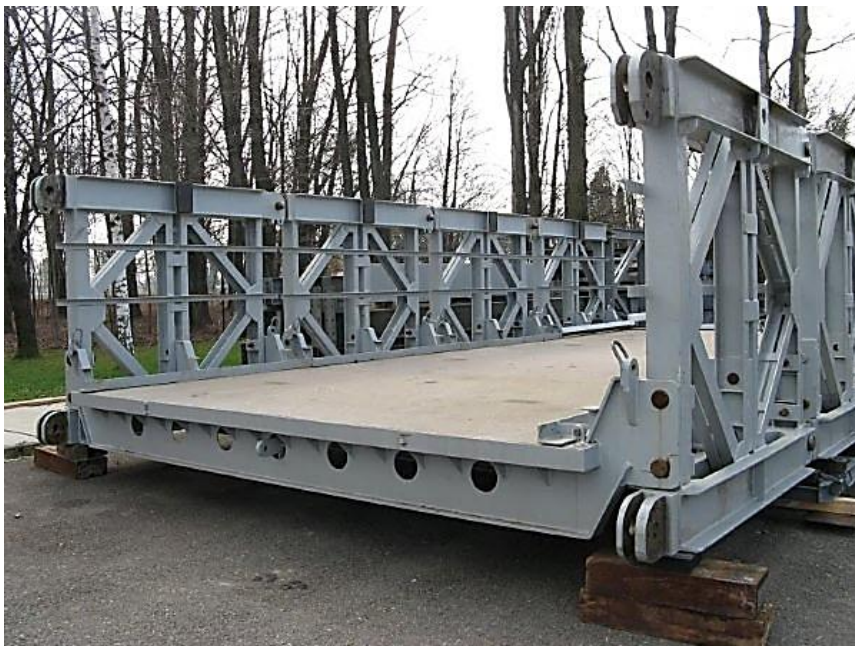
Obr. č. 2.9 Modernizovaná mostová souprava MMS
