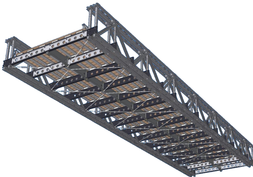
Obr. č. 3.3 Typický jednopatrový dvoustěnný most TMS – Z1p2s-21m
