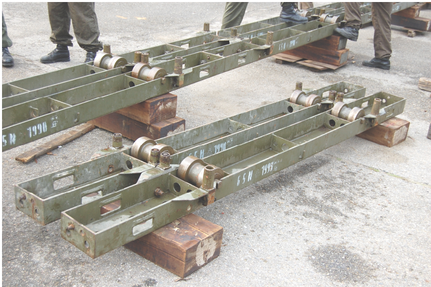
Stavba výsuvné dráhy
