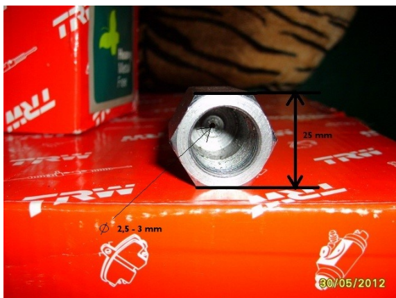
Mezikus upevnění kontrolní lambda sondy za katalyzátorem, otupující její reakci...
