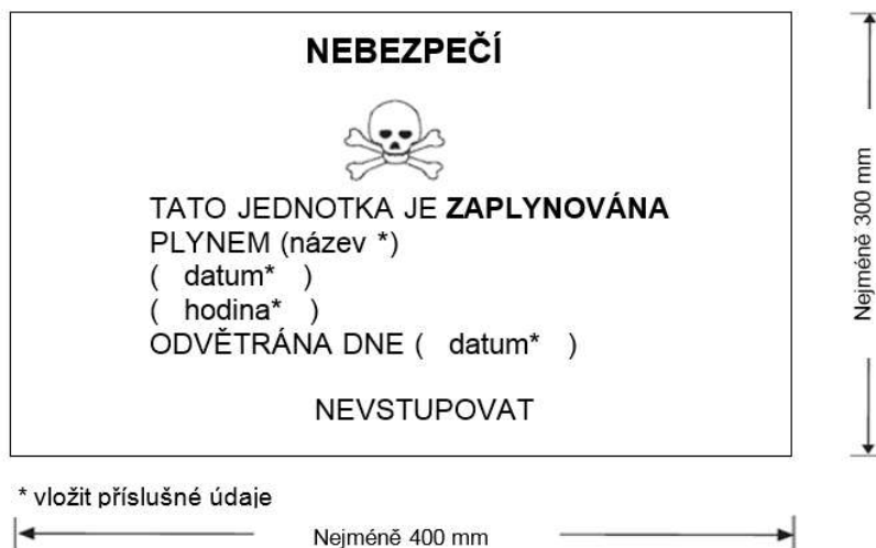
Výstražná značka pro zaplyňovanou jednotku
