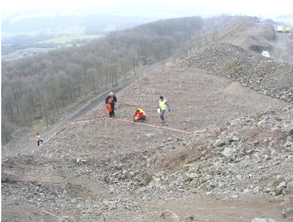
Dokumentační bod č. 4: pohled na JV na odlučnou oblast aktivního sesuvu. Stojící muž v tmavé bundě stojí v místě dosahu druhého aktivního poklesu (foto J. Klimeš, březen 2016).
