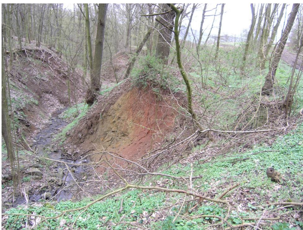
Dokumentační bod č. 18b: proti svahu zakloněný sesutý blok obnažený erozí potoka Uhelná strouha, pohled po proud na V (foto J. Klimeš, duben 2016).
