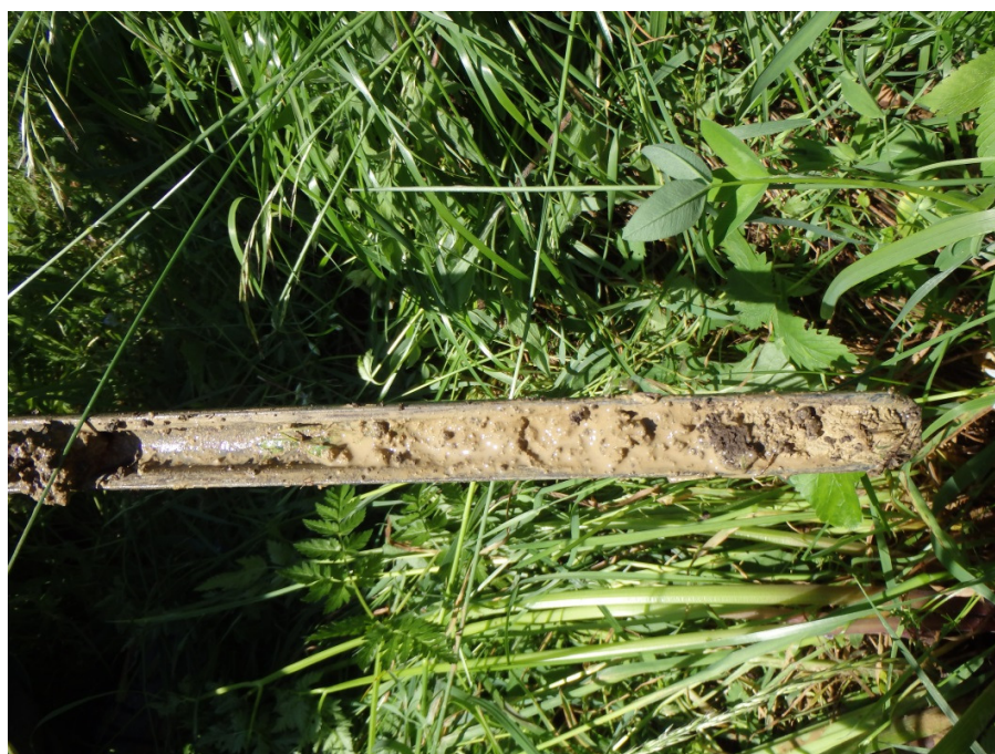
Přítomnost podzemní vody v mělké sondě těsně pod železniční tratí dne 5.6.2013
