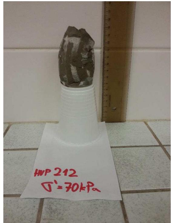
Obrázek 9.8: Fotodokumentace vzorků z triaxiálních zkoušek na slínovci ze smykové zóny, vzorek HV-P 212, hloubka 2,3 m.
