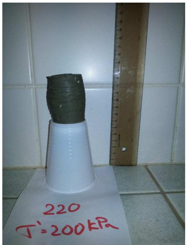
Obrázek 9.4: Fotodokumentace vzorků z triaxiálních zkoušek na slínovci ze smykové zóny, vzorek HV-P 220, hloubka 8,3 m.
