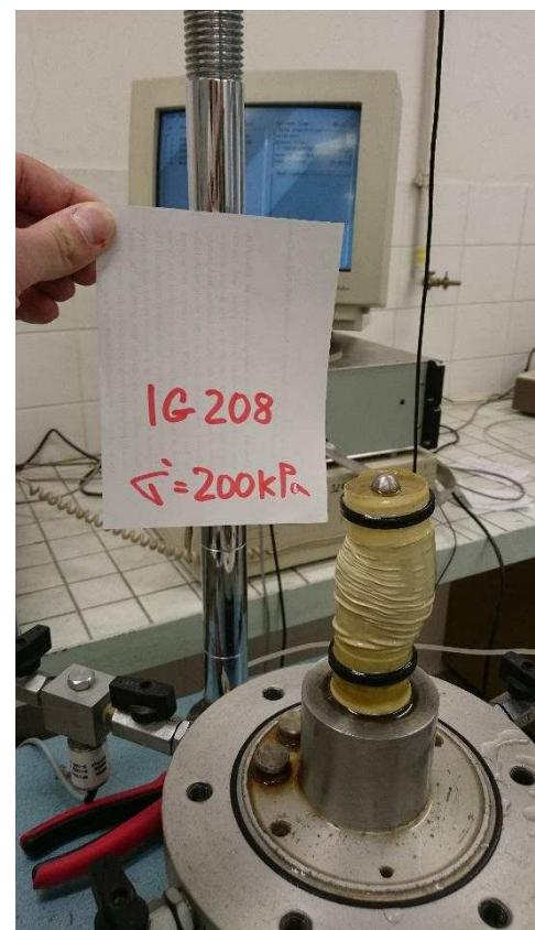
Obrázek 9.9: Fotodokumentace vzorků z triaxiálních zkoušek na slínovci ze smykové zóny, vzorek IG 208, hloubka 6,5 m.
