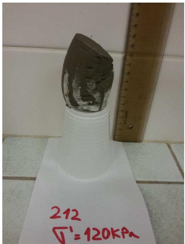
Obrázek 9.7: Fotodokumentace vzorků z triaxiálních zkoušek na slínovci ze smykové zóny, vzorek HV-P 212, hloubka 2,3 m.
