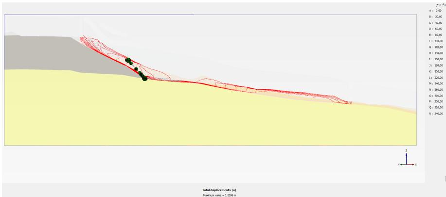
Obrázek 9.90: Model C (HPV na úrovni slínovce), řez 1 (řez A), izolinie deformací. Zřejmý sesuv pouze horní části svahu.
