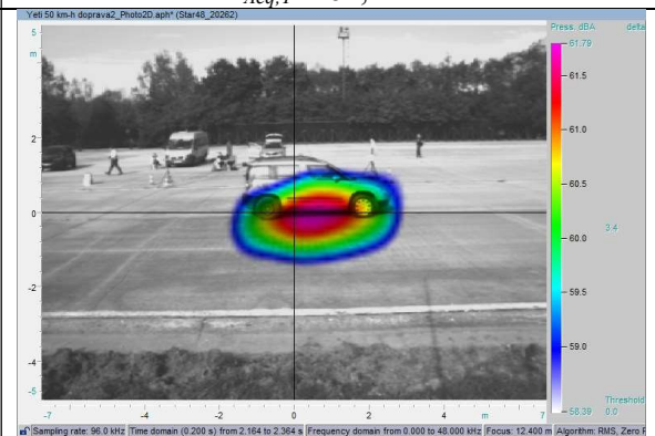
Škoda Yeti (diesel) Příspěvek do místa měření AK je L_{Aeq,T} = 61,7 dB.
