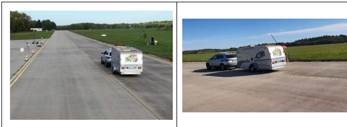
Obr. 23: Měřicí systém na měření hluku povrchů – EKOLA CPX
