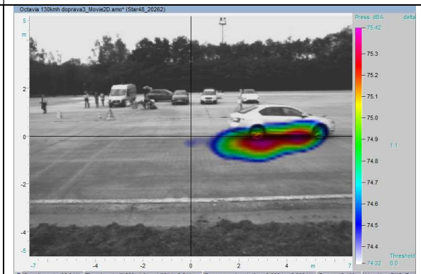
Škoda Octavia (benzín) Příspěvek do místa měření AK je L_{Aeq,T} = 75,4 dB.
