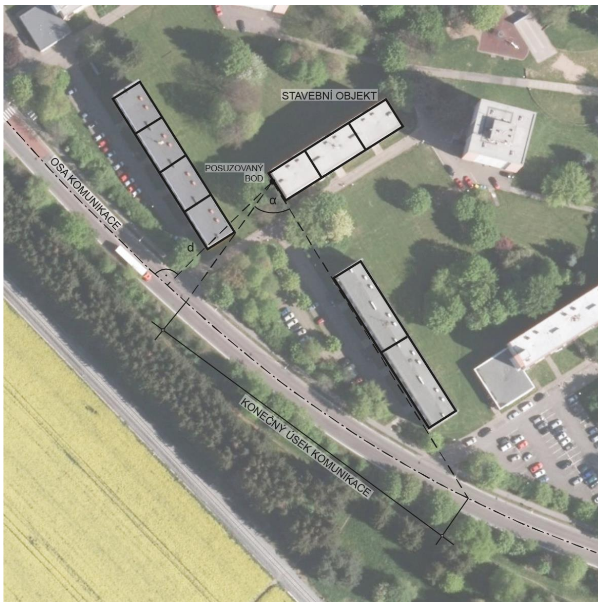
Obr. 3: Stanovení úhlu \alpha pro konečný úsek komunikace
