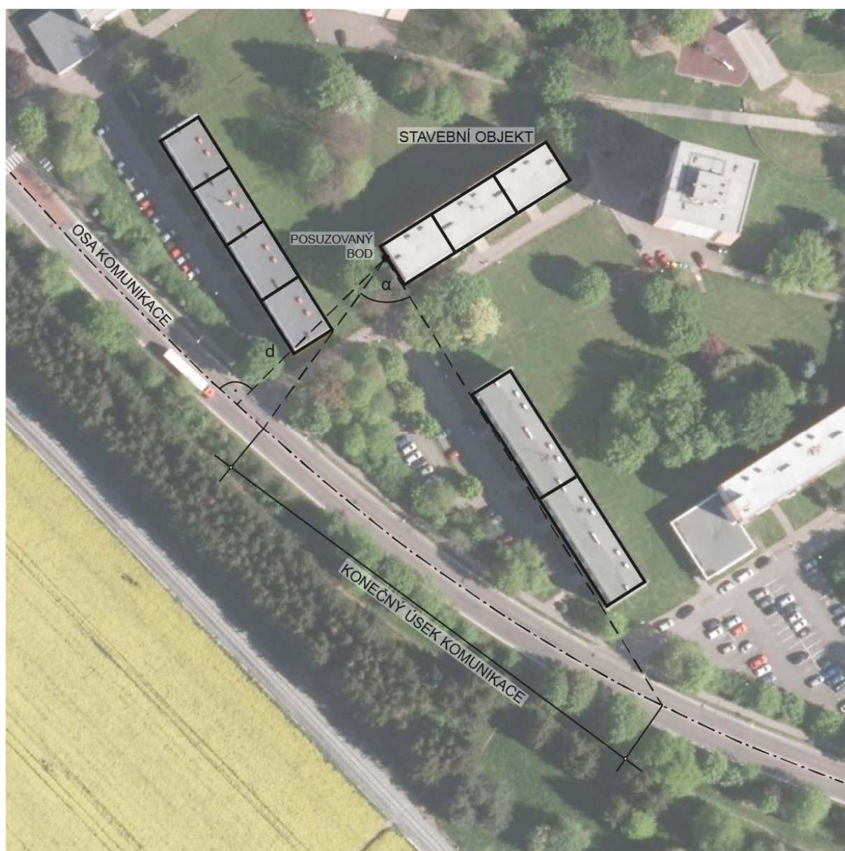
Obr. 3: Stanovení úhlu \alpha pro konečný úsek komunikace
