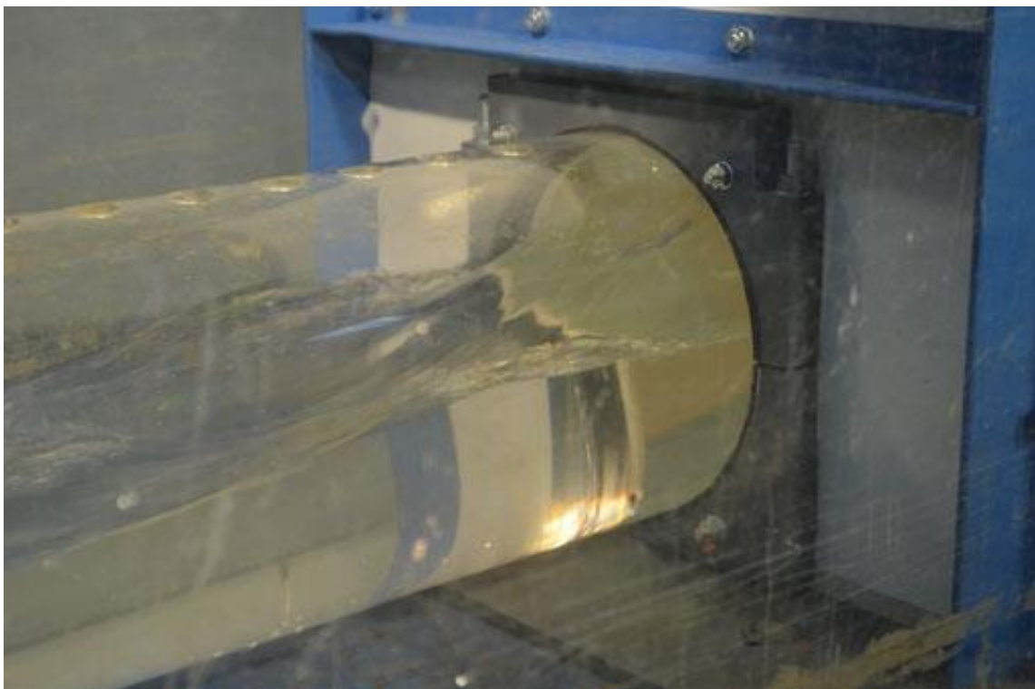
Foto 4.1 Pohled na proudění v propustku s kolmým čelem při proudění s volnou hladinou a zatopeným vtokem
