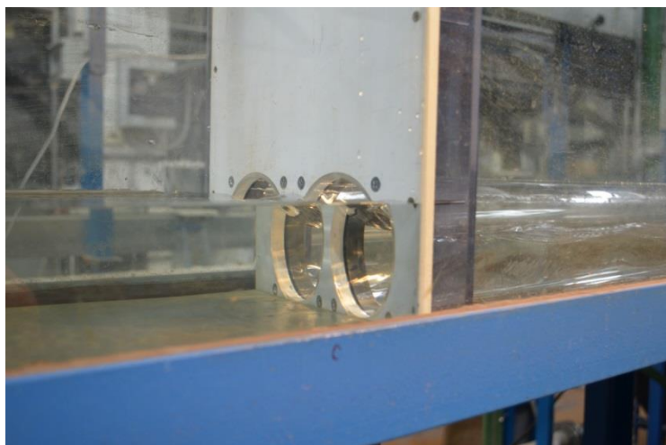
Obr. 5.2 Fyzikální model propustku tvořeného 2 paralelními rourami
