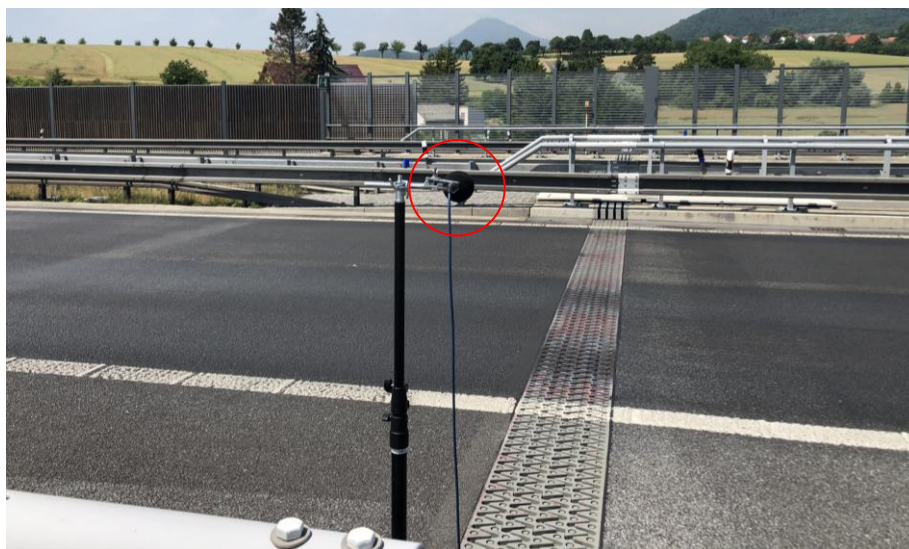
Obrázek 16: Umístění mikrofonu nad mostním závěrem (v ose závěru) – ilustrační foto
