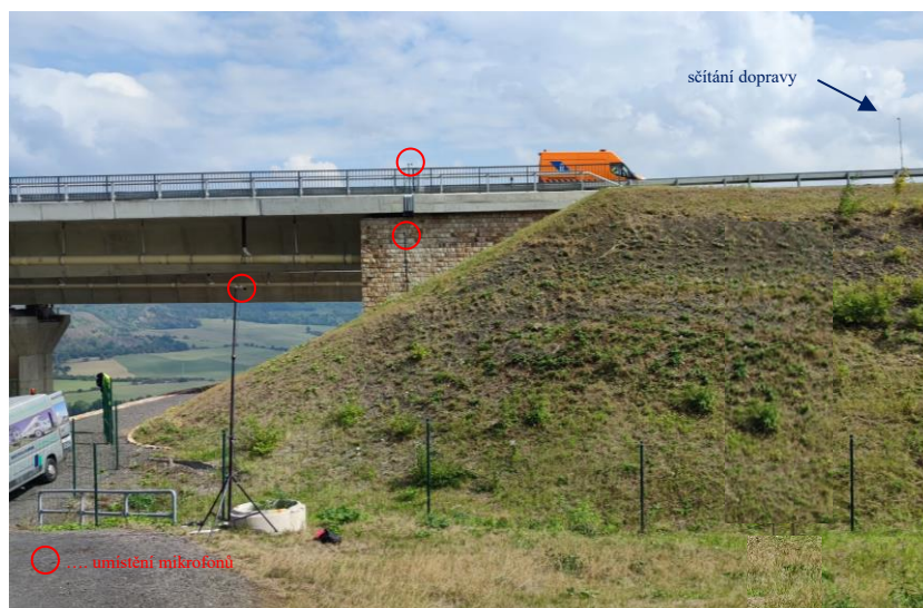
Obrázek 19: Umístění mikrofonů ve vzdálenostech 30 m a 60 m od mostního závěru (v ose závěru) a umístění zařízení pro sčítání dopravy – ilustrační foto
