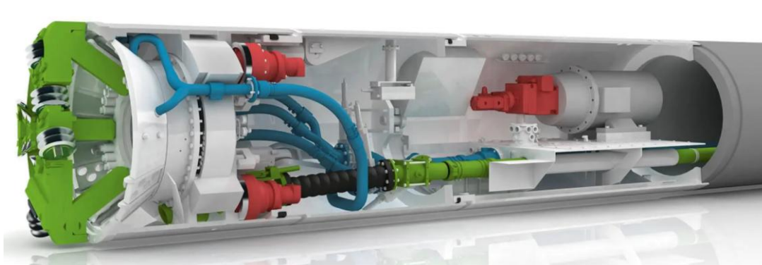
Obrázek 4: Schéma tunelovacího stroje typu Slurry TBM
