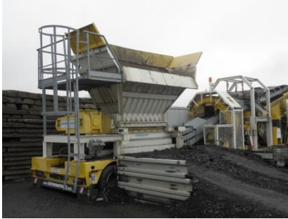
Obrázek 1 Stacionární technologická linka pro drcení asfaltového recyklátu
