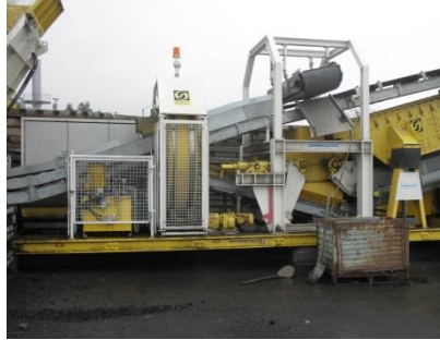
Obrázek 1 Stacionární technologická linka pro drcení asfaltového recyklátu
