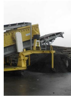
Obrázek 1 Stacionární technologická linka pro drcení asfaltového recyklátu
