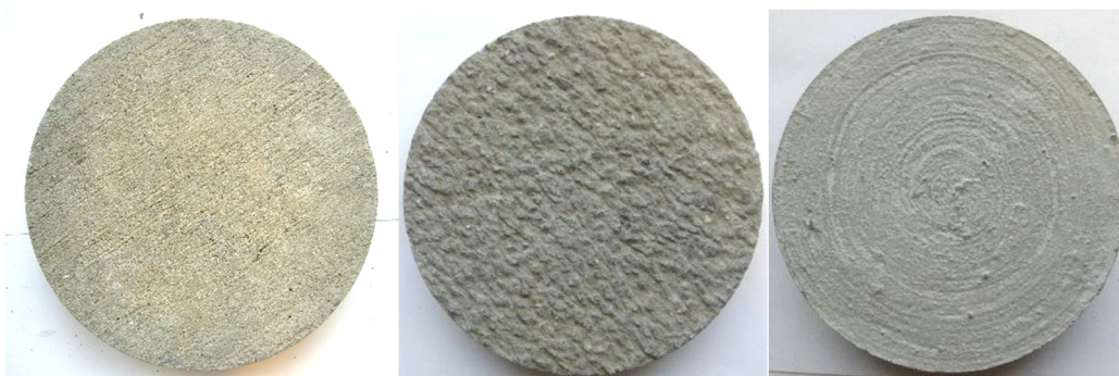
Obrázek 3 – Zkušební vzorky – vývrtky z vozovek (vlevo a uprostřed), vzorek vyrobený v laboratoři (vpravo)
