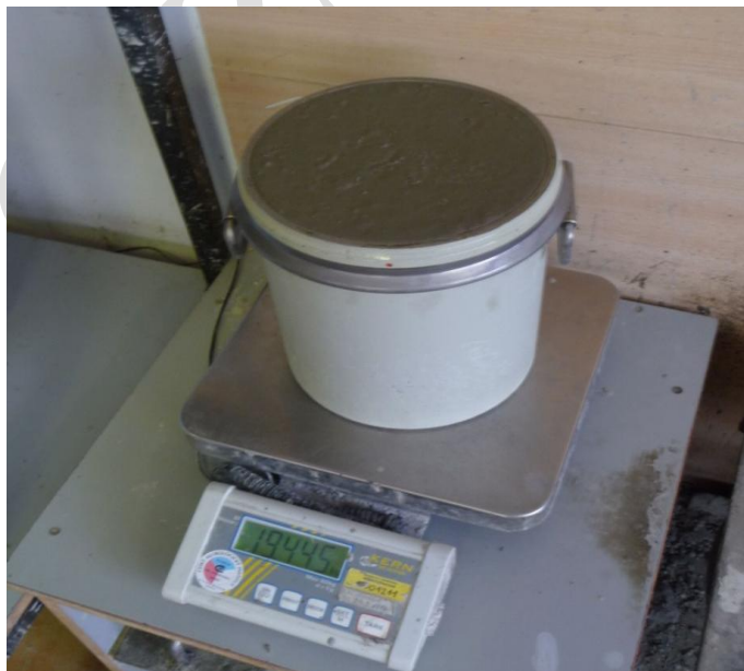
Obr. 4: Zjištění objemové hmotnosti čerstvého UHPC v hrnci pro měření obsahu vzduchu podle ČSN EN 12350-7
