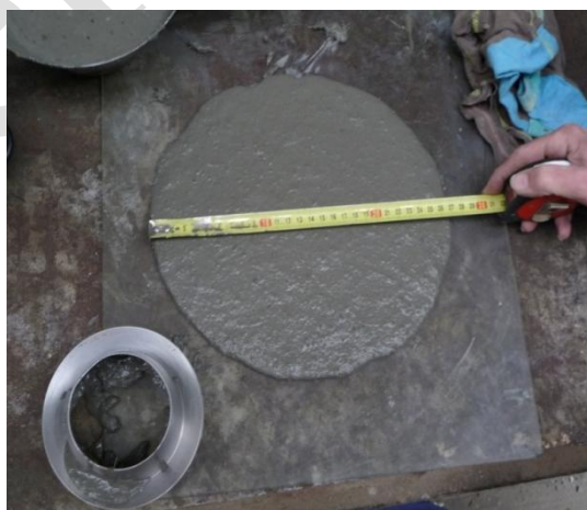
Obr. 3: Kontrolní zkouška čerstvého UHPC rozlitím s využitím kužele na testy malty dle EN 1015-3
