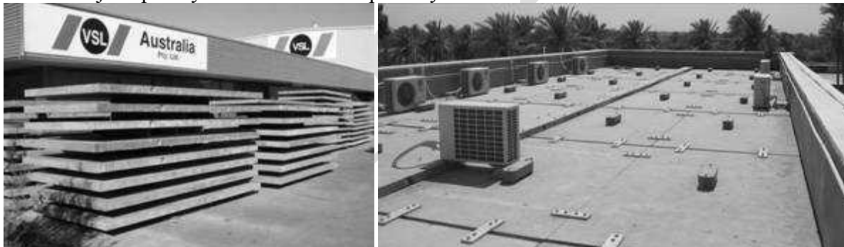
Obr. 38 Výroba a použití panelů z UHPC zajišťující ochranu při výbuchu, Austrálie (zdroj [76])
