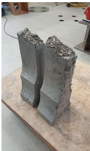
Obr. 11: Porušení zkušební tělesa typu „dog-bone“ po zkoušce pevnosti v prostém tahu.
