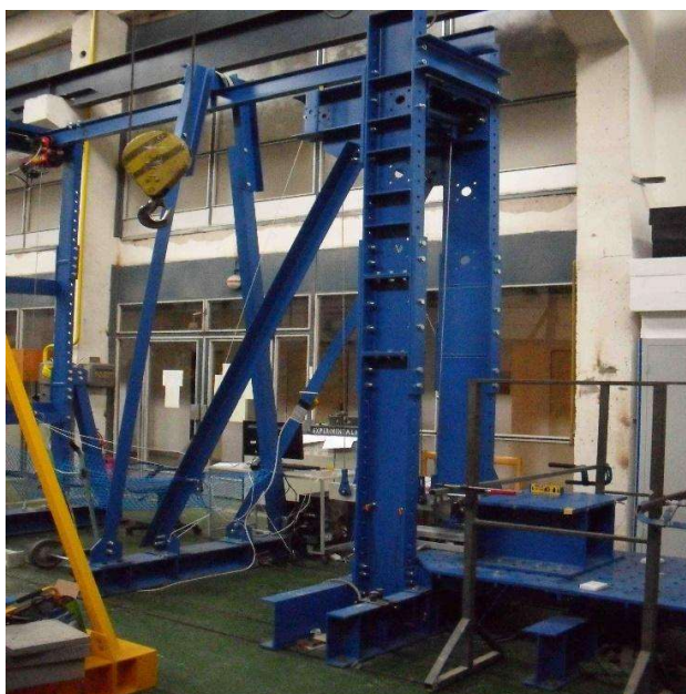
Obr. 12: Zařízení pro provádění rázové zkoušky betonových zkušebních těles.
