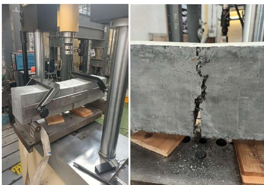
Obr. 10: Uspořádání zkoušky tříbodovým ohybem pro záznam deformační křivky betonu.
