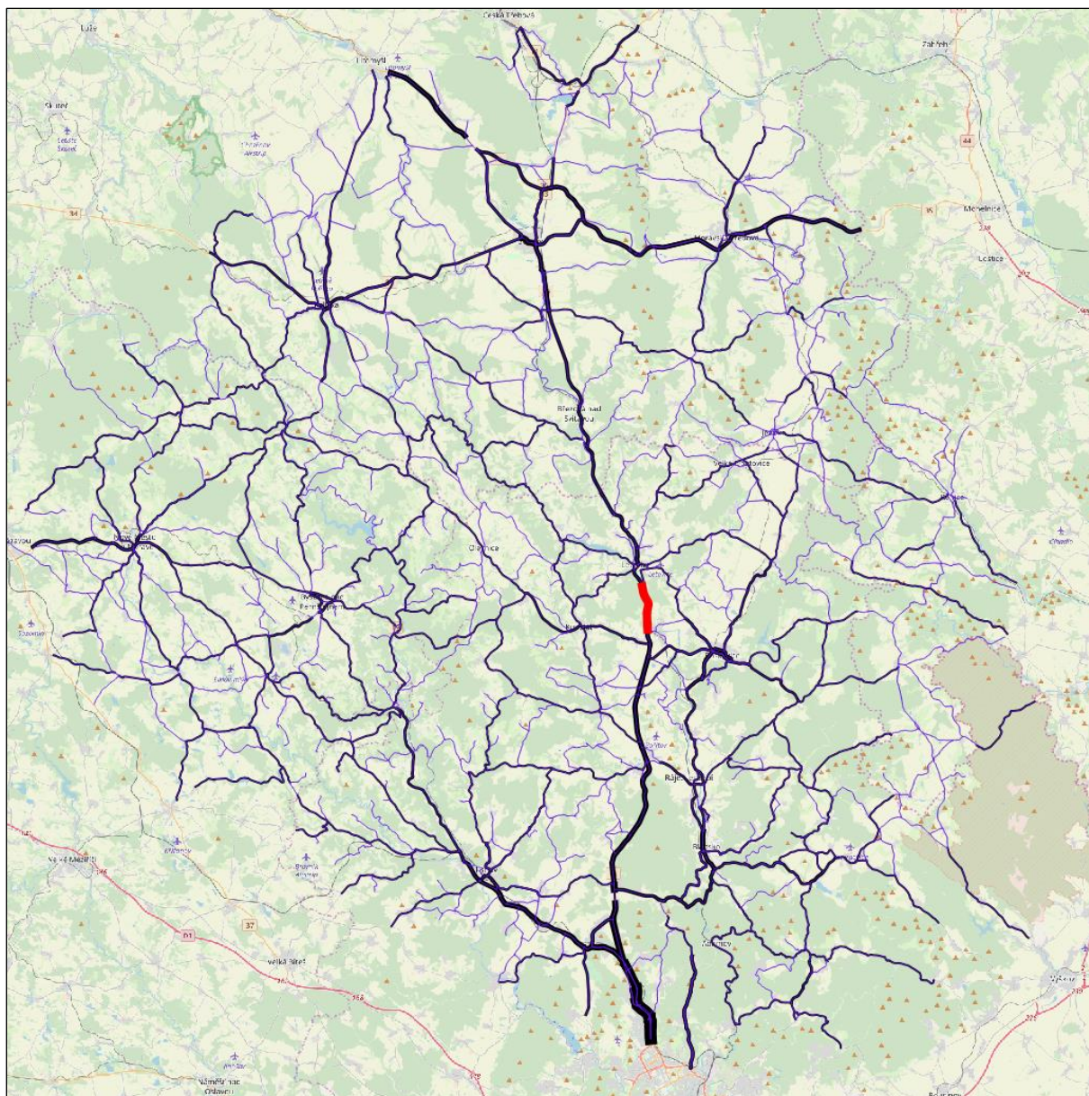
Obr. P2. Vizualizace celé silniční sítě (fialová barva) a úseků s dostupným sčítáním dopravy (černá barva s proměnlivou tloušťkou) na zájmovém území, kde došlo vlivem hypotetické povodně k uzavírce červeně zvýrazněného úseku (11 092 vozidel / 24 hod).
