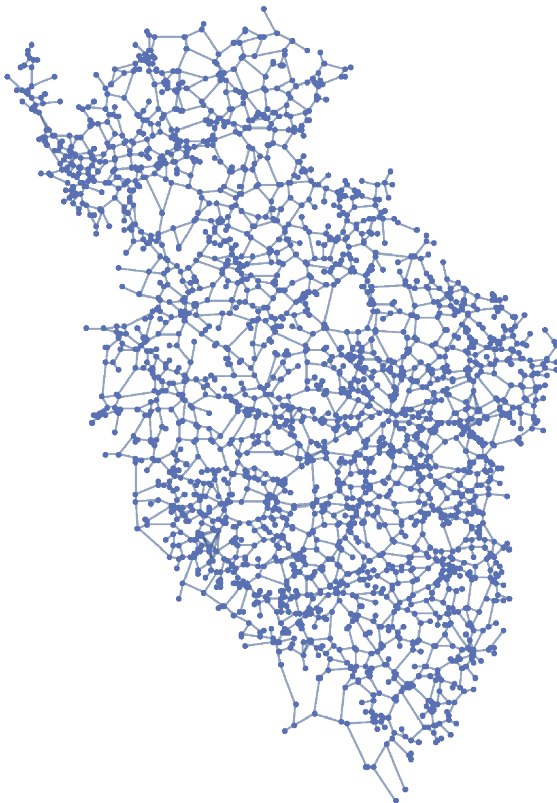
Obr. 3.5. Ukázka grafu reprezentujícího část silniční sítě ČR (Plzeňský Kraj, obr. 2.2). Z hlediska zranitelnosti této sítě je zřejmé, že přestože řada okrajových uzlů má pouze jedno napojení, nemusí se nutně jednat o jinak izolované uzly, ale pouze hranice správního celku, za nímž existují další napojení. Je tedy vždy na místě posouvat danou síť v kontextu a měřítku, které odpovídá testovacímu scénáři.
