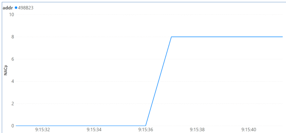
Obrázek P1.1.: Průběh parametru NAC_p v prvních okamžicích po vzletu; Naměřeno během experimentů v Brně 12.11.2020
