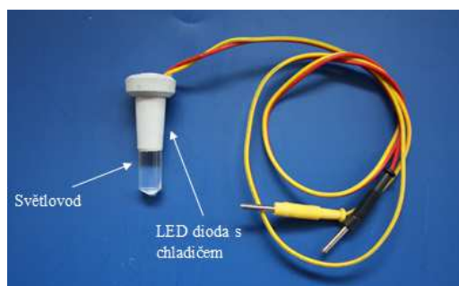
Obr. 3.10: Výměnný zdroj světla, který se skládá z LED diody s chladičem.
