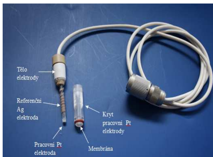
Obr. 3.8: Kyslíková elektroda složená z těla elektrody, referenční Ag elektrody, pracovní Pt elektrody, krytu pracovní Pt elektrody s membránou. Elektroda je v krytu ponořena do elektrolytu KCl.
