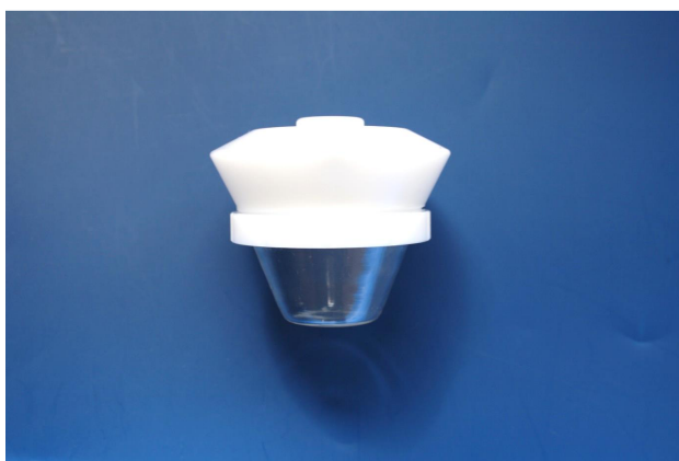
Obr. 3.4: Rozebíratelná reakční nádoba bez příslušenství.
