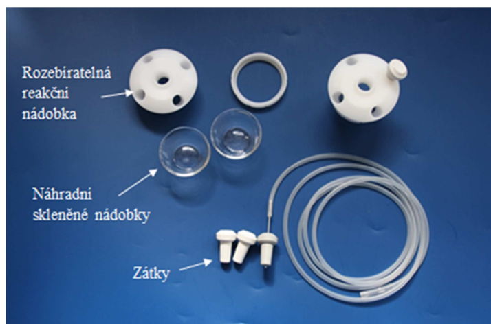
Obr. 3.5: Rozložená reakční nádobka, včetně příslušenství.
