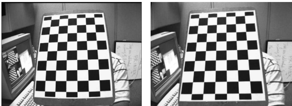
Obr. 4.4: Příklad obrázku před potlačením distorze (vlevo) a po potlačení distorze (vpravo).
