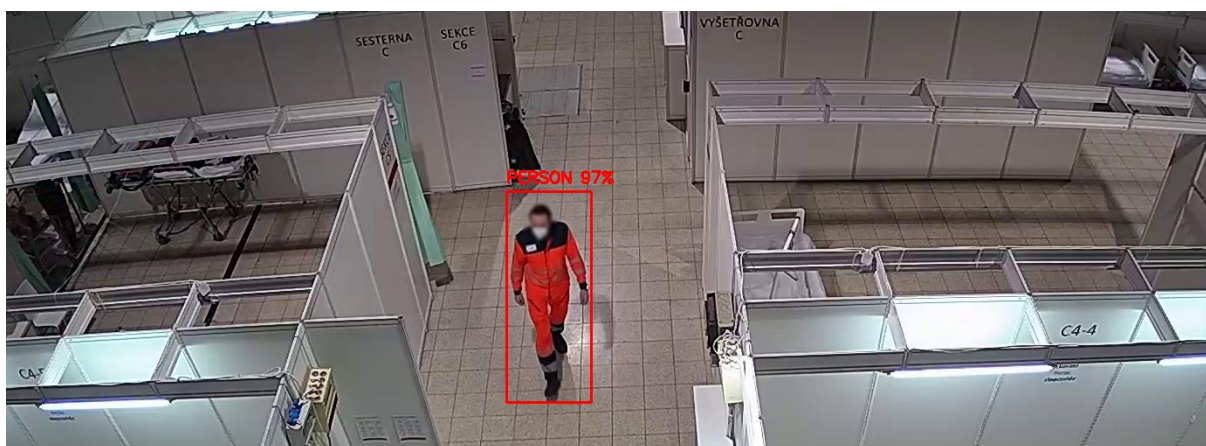
Obr. 4.1: Ukázka detekce chodce algoritmem YOLO s uvedenou pravděpodobností úspěšné detekce.
