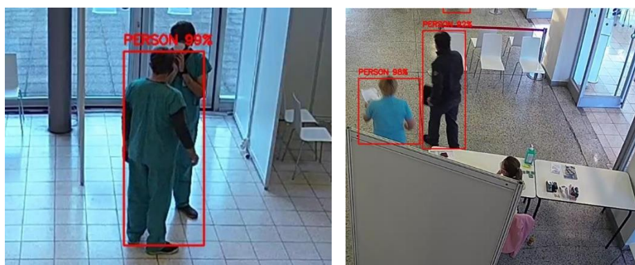
Obr. 4.6: Příklad ztráty polohy osoby vlivem překrytí dvou osob (vlevo) a nepřesné detekce dané statickým objektem v zorném poli kamery (vpravo).
