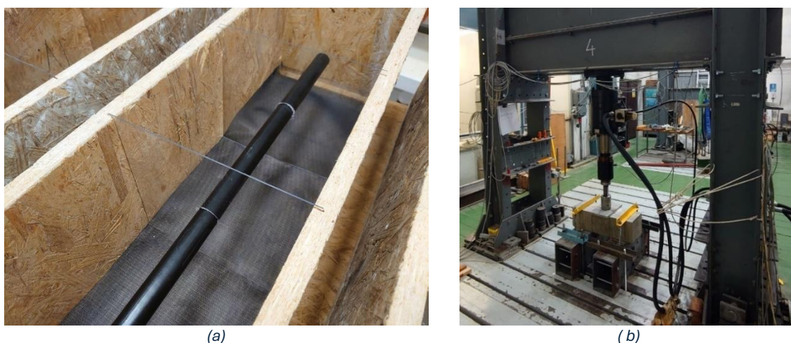
Obrázek 7: Příklady (a) realizace uchycení kluzného trnu v bedně při výrobě zkušebních vzorků a (b) uchycení zkušebního vzorku do zatěžovacího stroje
