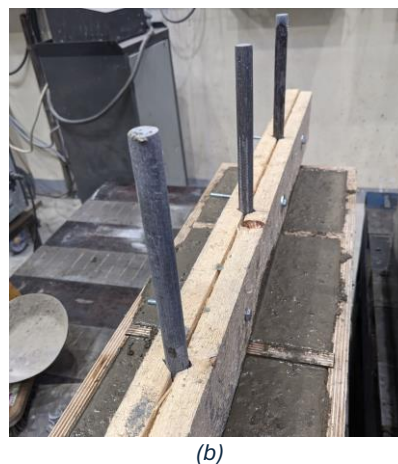
Obrázek 8: Schéma rozměru testovacího vzorku pro zkoušku přídržného/třecího smykového napětí při vytahování kluzného trnu (a) a příklad výroby sady tří vzorků v laboratoři (b).
