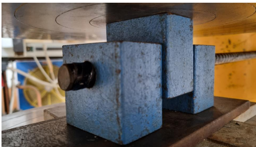
Obrázek 4: Příklad zatěžovacího přípravku pro určení únosnosti kluzného trnu ve střihu
