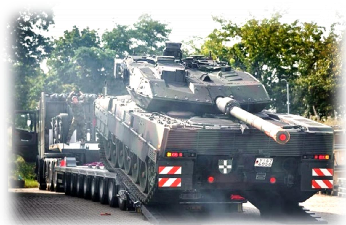
Rozložení celkové hmotnosti na 12 náprav (4 + 8) \times 10,12t = 121,4t
