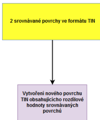
Obr. 4.2 Schéma postupu rozdílové analýzy pro kombinaci dvou povrchů TIN
