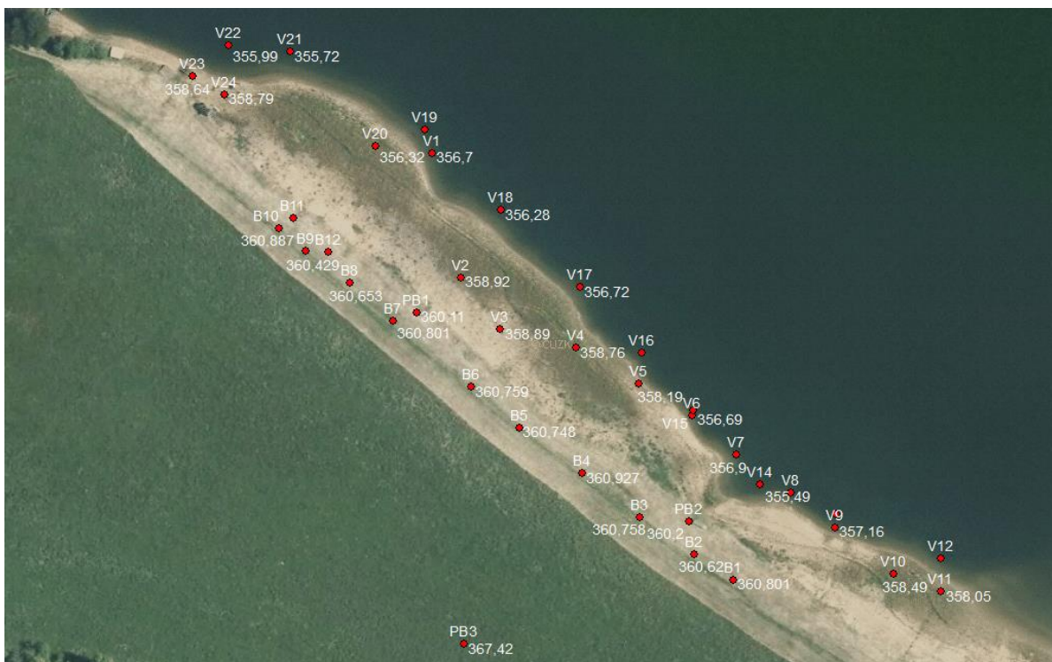
Obr. 4.3 Příklad diskrétních bodových dat udávajících výškové kóty dna a označení tachymetricky zaměřených bodů na VN Letovice
