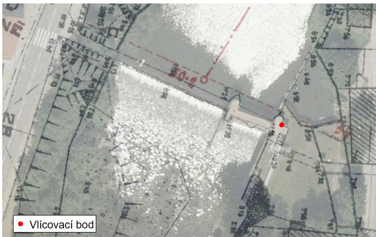
Obr. 2.1 Příklad vhodného vlčovacího bodu sloužícího ke georeferencování situačního výkresu
