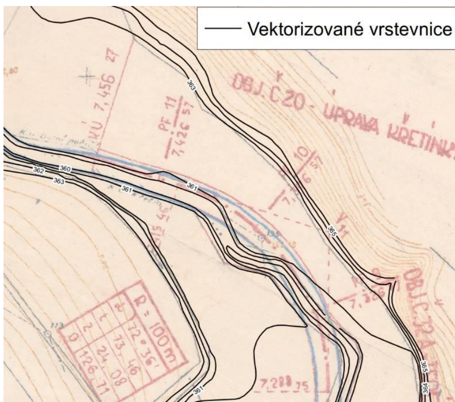
Obr. 2.4 Ukázka vektorizace vrstevnic na podkladu situačního výkresu zátopy vodní nádrže
