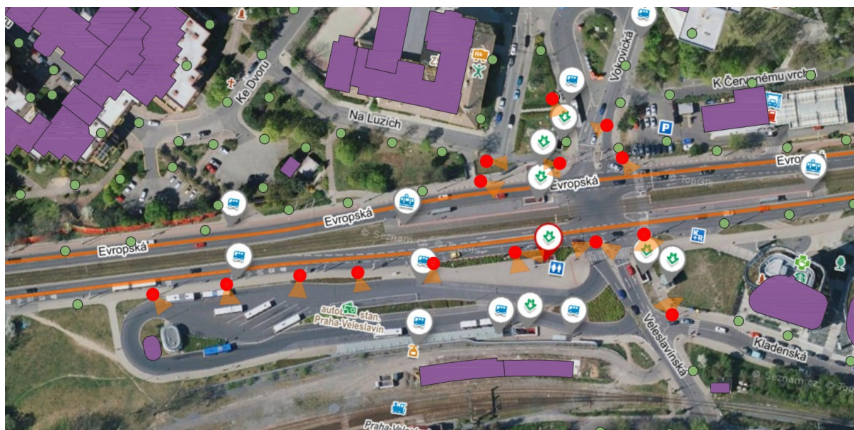
Obrázek 9: Požadované stožáry VO k umístění kamer VDT v oblasti terminálu Nádraží veveřslavín.
