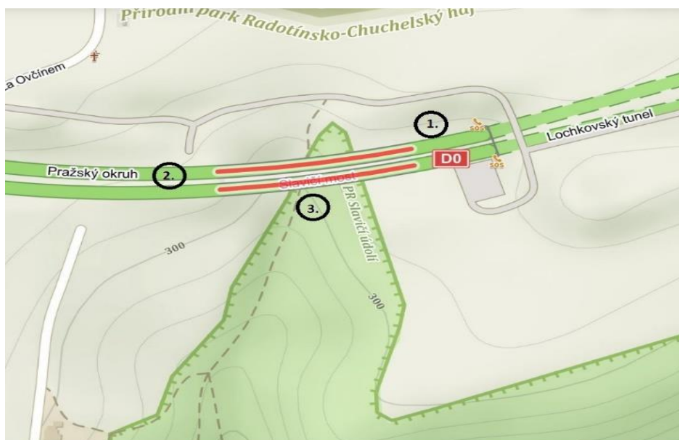
Obr. 15. Slavičí most a okolí; mapový podklad dle [55]. 1- Lochkovský tunel – kabelovod vedený pod mostem pro dodávku el. Energie pro zabezpečovací systém tunelu. 2- D0 směr Plzeň - kanalizace vedená pod mostovou Slavičího mostu. 3- 3. Svah s erozí půdy – Slavičí údolí.
