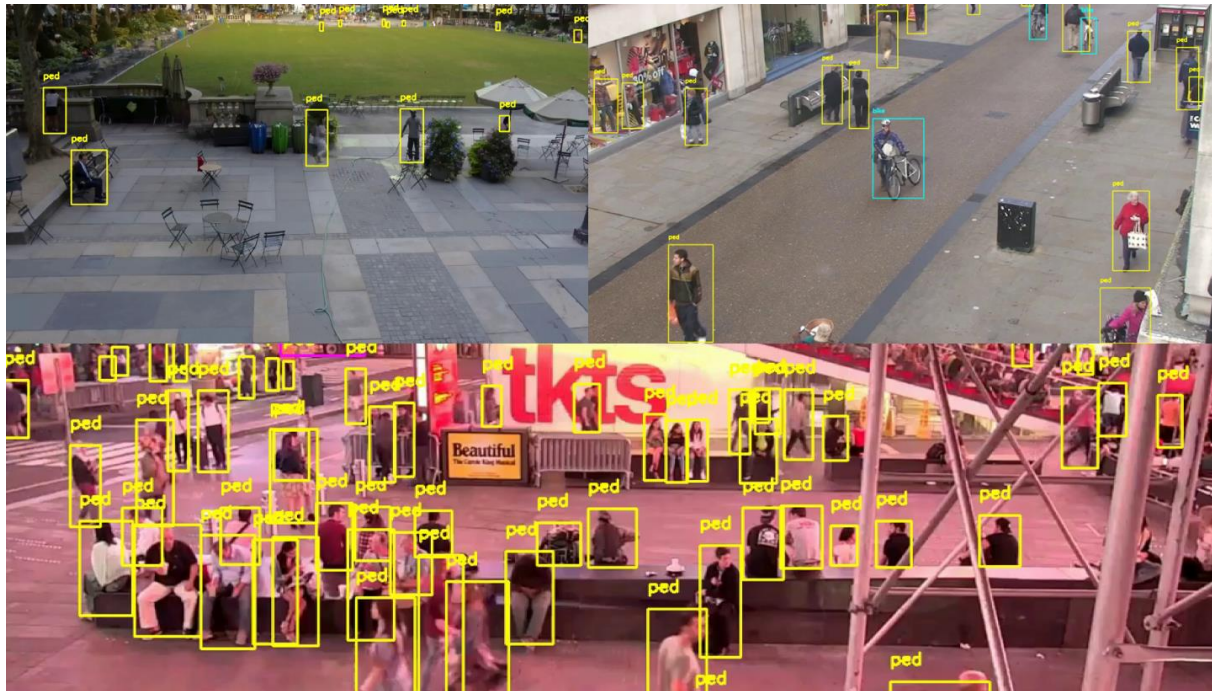
Obr. 2.3: Příklad záběru z monoskopického systému, kde detekce je prováděna přímo z obrazu - Optimální úhel kamery (vpravo nahoře).
