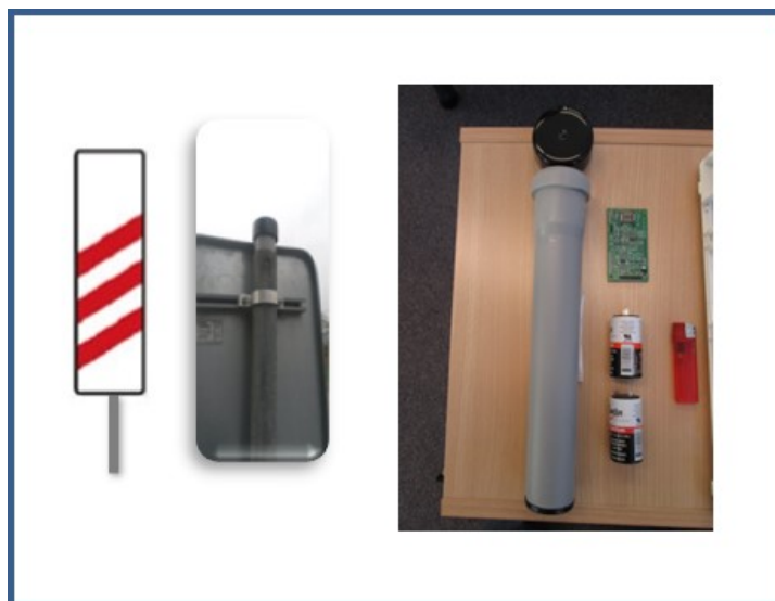
Obr. 3 – RSE / jednotka na infrastrukturu užitá v projektu VG2VS/155
