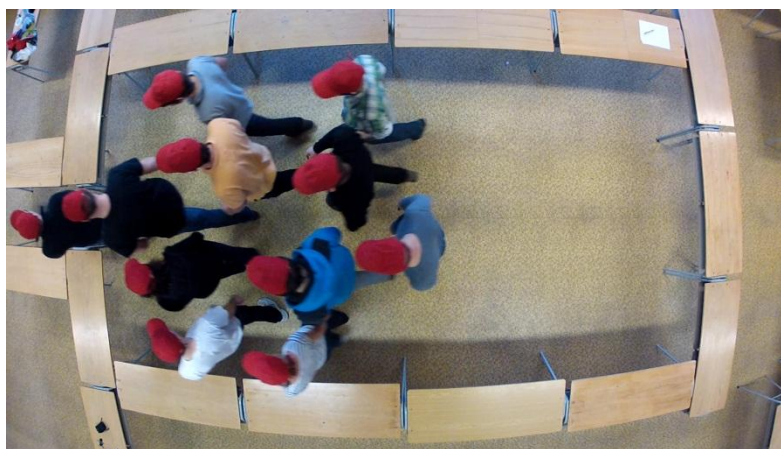
Obrázek 11 – Příklad sférického zkreslení při záběru z výšky 4 metrů a úhlu záběru 127^\circ .
