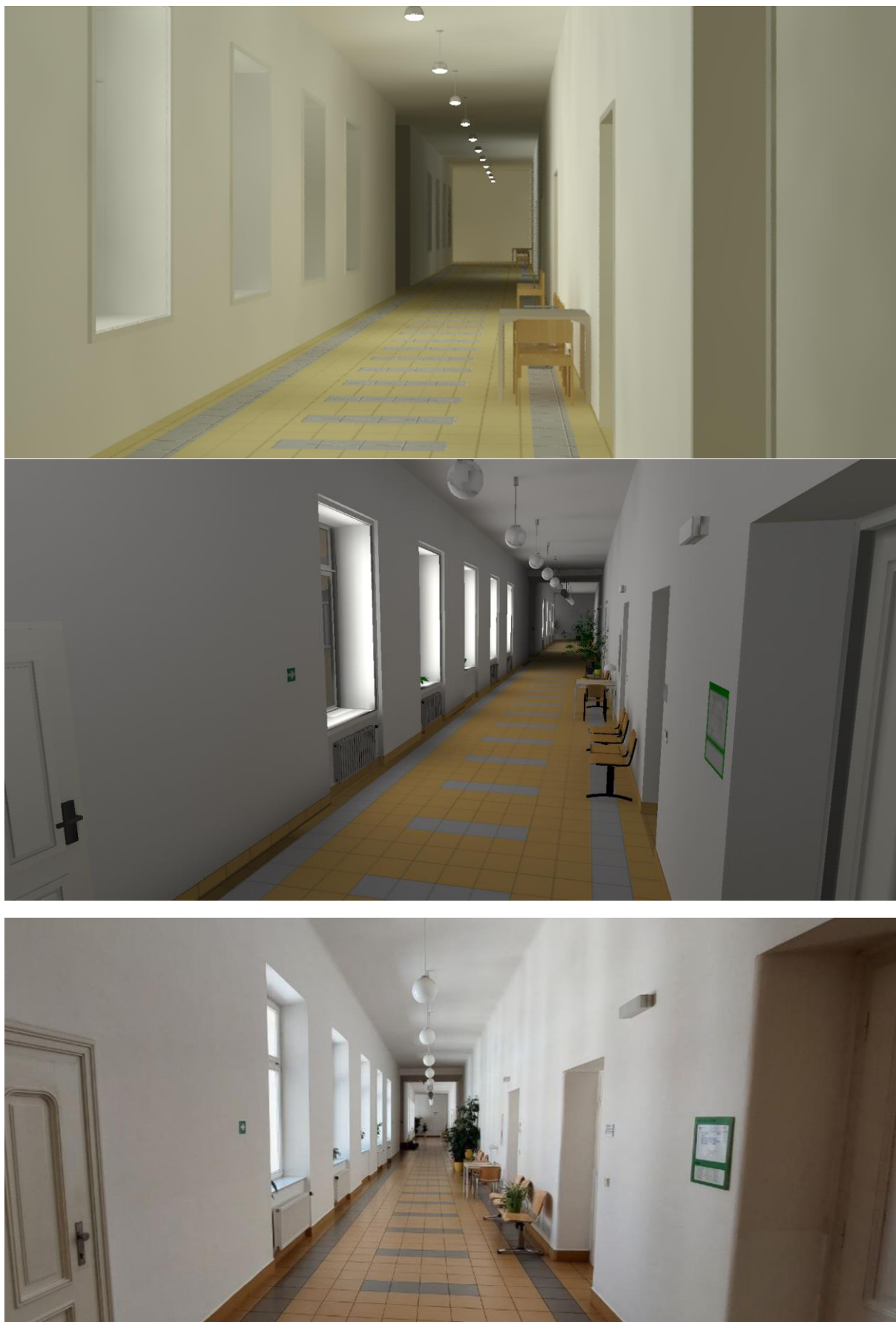
Obr. 9: BIM model příkladové budovy (nahore), upravený model pro VR (uprostřed) a její reálná podoba (dole).
