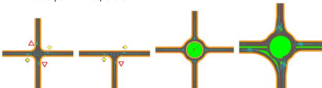
Obr. 5 Základní tvary křižovatek dle ČSN 73 6102
