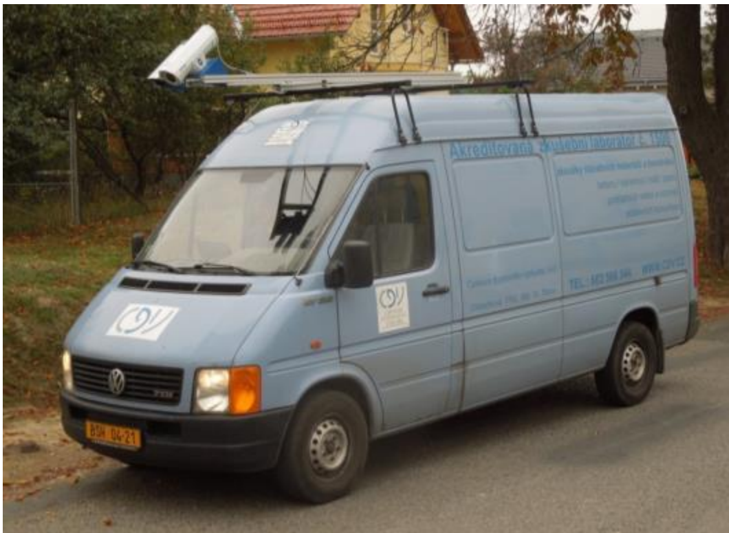
Obr. 10: Příklad měřícího vozidla s osazenou termokamerou a digitální kamerou na střeše, zdroj: CDV
