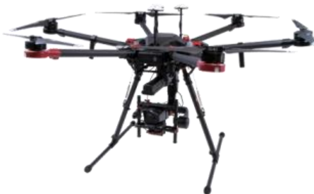
Obr. 11: Vozovka na mostech s viditelným rozdílem mezi jednotlivými pásy (vlevo), Dron DJI M600 Pro s termokamerou WIRIS (vpravo), zdroj: www.workswell.cz
