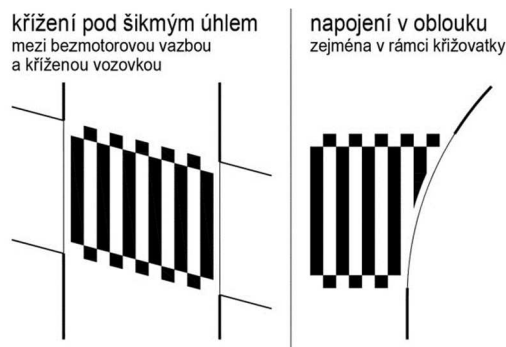
Obr. 2 Detail napojení, křížení šikmé a v oblouku [3]
