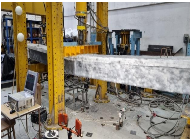
Obr. 4. Statické zatěžovací zkoušky ve zkušební laboratoři č. 1048 akreditované v ČIA.
