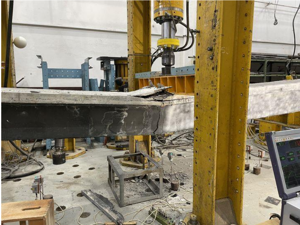
Obr. 15. Delaminace horní části průřezu krátce po dosažení maximálního zatížení.
