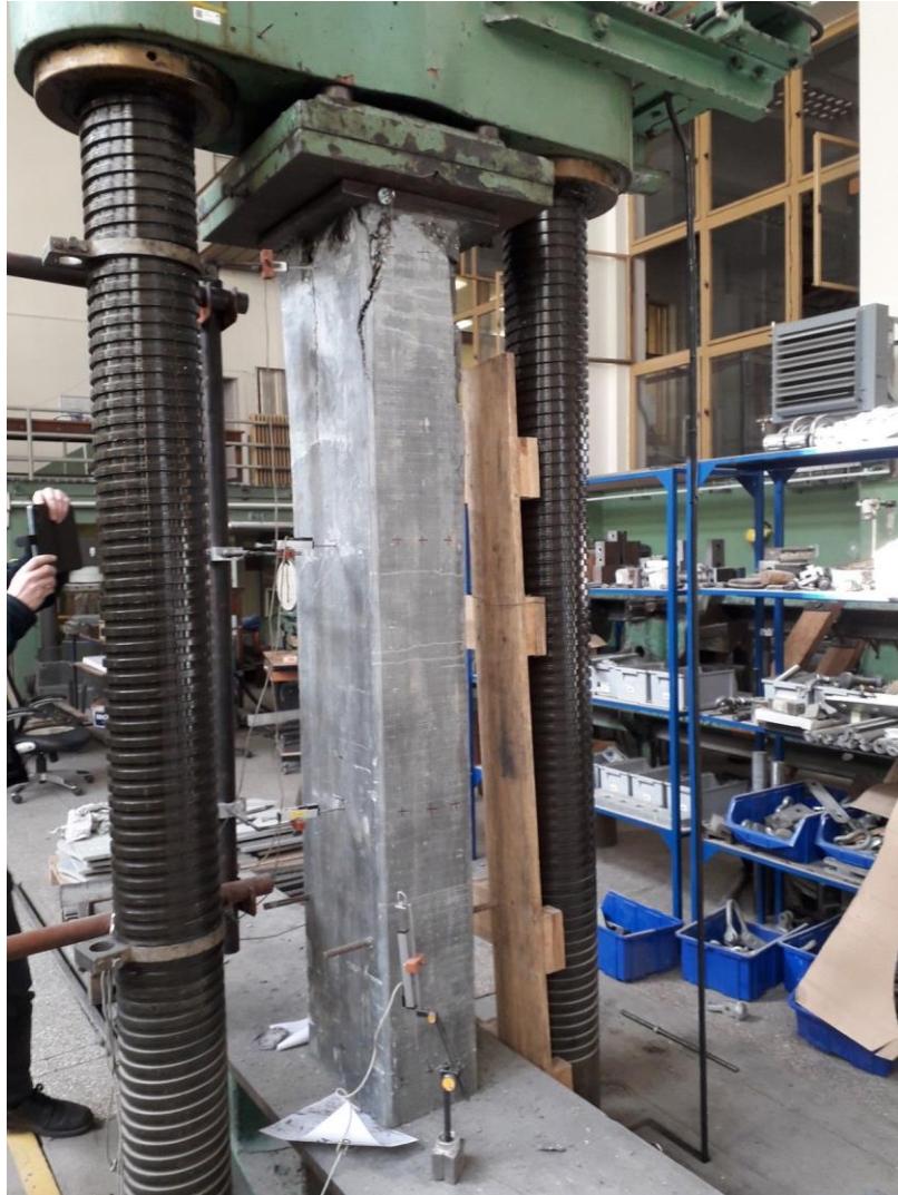
Obr. 20. Kompozitní sloup v centrickém tlaku po porušení.
