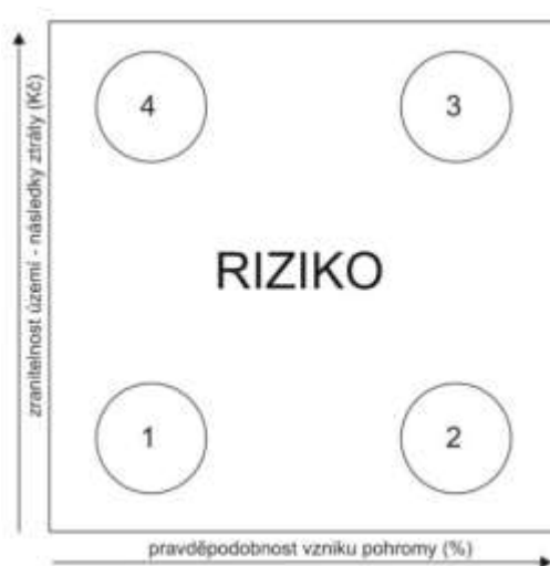
Schéma 2: Ukázka diagramu rizika jako součinu pravděpodobnosti vzniku negativního jevu a jeho následků.
