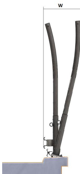
Obr. 1 – Vyhodnocení pracovní šířky w u svodidel s integrovanou PHS
