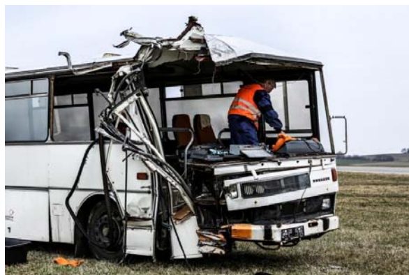
Obr. 2 – Nepřípustná deformace a roztržení skeletu autobusu po nárazu
