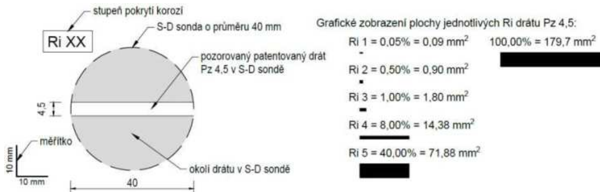
Obr. 83 Ukázka obrazového standardu patentovaného drátu Pz 4,5
