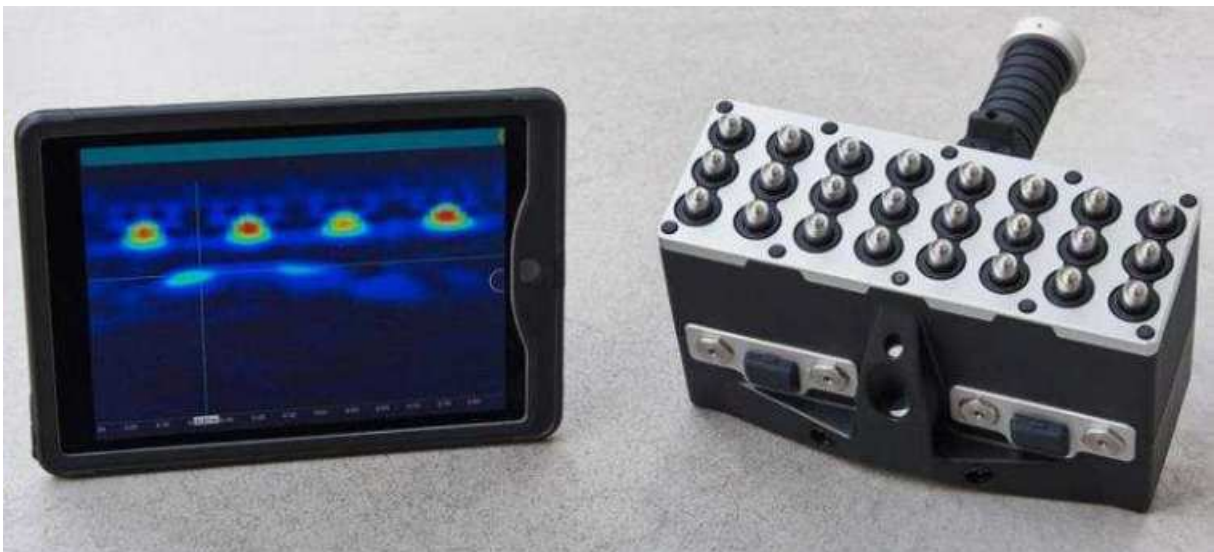
Obr. 27 Ukázka vybavení pulse echo metody [9]
