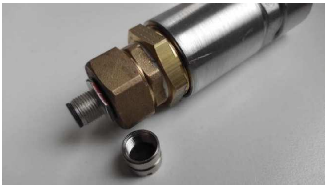
Obr. 159 Pouzdro se snímačem vlhkosti zalepeným v zátce a vloženým konektorem pro sběr dat
