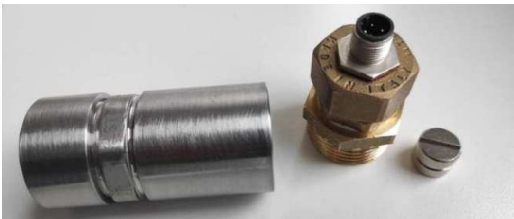
Obr. 158 Pouzdro se snímačem vlhkosti zalepeným v zátce a vloženým konektorem pro sběr dat
