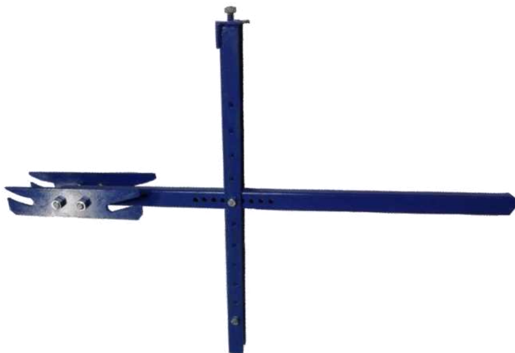
Obr. 116 Pohled na závěs s teleskopickou pákou
