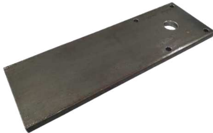
Obr. 132 Přípravek pro ověření injektáže a koroze v oblasti před kotvou – fotografie
