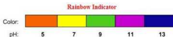
Obr. 71 Stupnice pH pro orientační zkoušku pomocí pH indikátoru (Rainbow Indicator) Zdroj: http://germann.org/products-by-application/carbonation/deep-purple-and-rainbow-indicator
