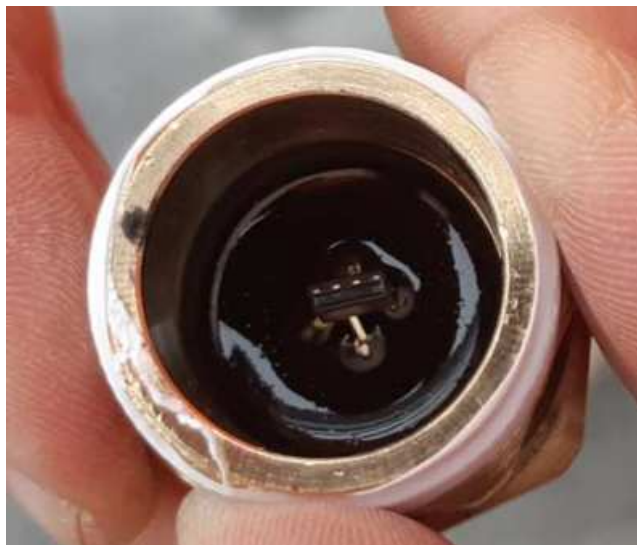
Obr. 157 Snímač vlhkosti Honeywell HIH8121 a utěsnění konektoru polyuretanovou zalévací hmotou
