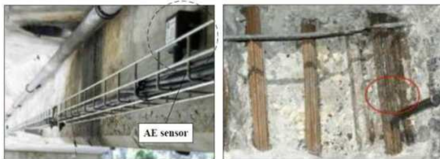
Obr. 29 Ukázka použití metody AE pro detekci porušení předpínací výztuže [20]
