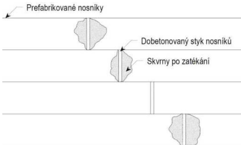
Obr. 9 Schématický náčrt skvrn po zatékání, které se objevují v okolí příčných spár prefabrikovaných tyčových nosníků.
