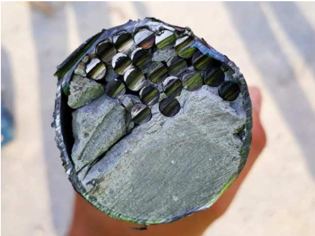
Obr. 49 Rozmístění drátů v plně zainjektovaném kabelovém kanálku
