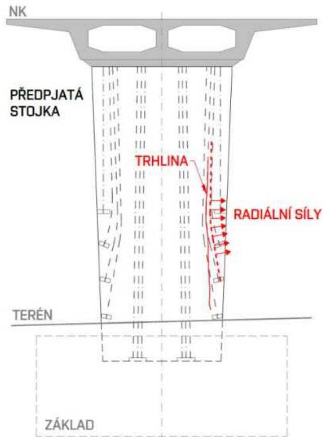
Obr. 37 Schematický náčrt působících radiálních sil ve stojce a vznik trhliny ze statických příčin.
