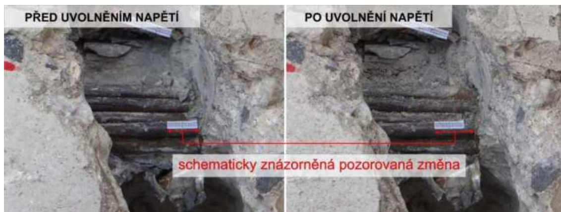
Obr. 9 Ukázka obrazového materiálu z měření pokluzu předpínací výztuže. Vlevo je zobrazen stav před uvolněním napětí, vpravo stav po uvolnění napětí (po realizovaném pokluzu)
