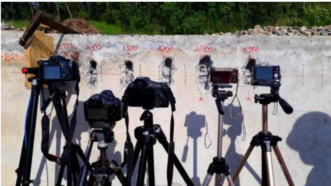
Obr. 7 Digitální fotoaparáty v pozicích během měření pokluzu drátů
