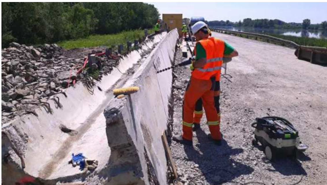
Obr. 5 Vrtání semidestruktivních sond pro experimentální měření
