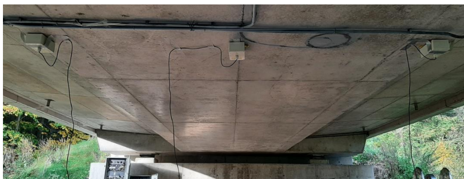
Obrázek 6: Testování vybraných digitálních MEMS akcelerometrů pro potřeby vývoje jejich integrace s WIM systémem
