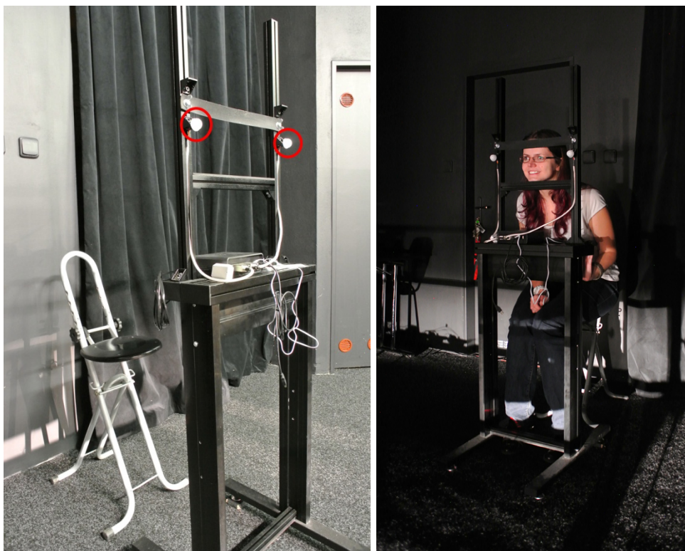
Obr. 11: Stojan pro řidiče s opěrkou hlavy, vybavenou luxmetry (zvýrazněno červeně), a usazení řidiče
