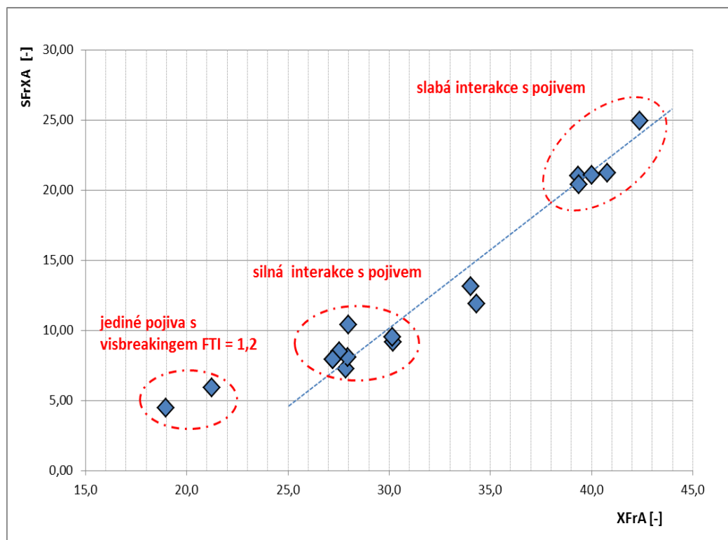
Obrázek 25: Porovnání vztahu kritických veličin FrX_A a SFrX_A , separace vlivu gradientu změny, 135 °C, D = 2s^{-1}
