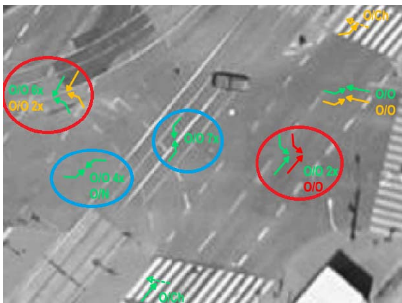
Obr. 21 Část konfliktního diagramu s vyznačením nejčastějších konfliktů (příklad č. 1)
