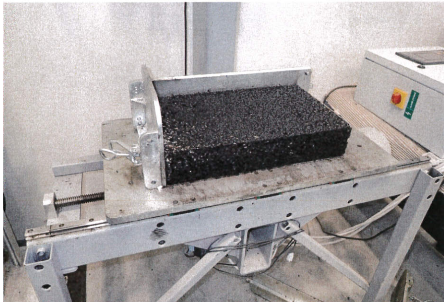
Obrázek 8 - Spodní pojezdový stůl zhutňovače s vyrobenou zkušební deskou
