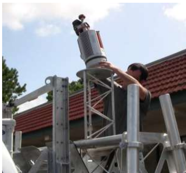
Obrázek 16: Instalace laserového skeneru na vozidlo. [5, s. 6]
