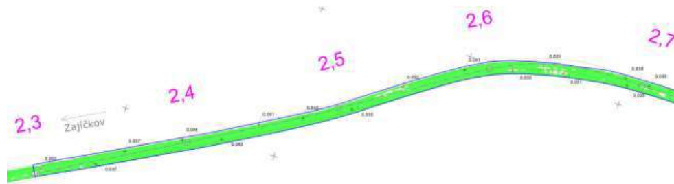
Obrázek 9: RDMT – červeně jsou označena místa, kde projektovaná tloušťka není dodržena o více jak 20 %. [2, s. 50]
