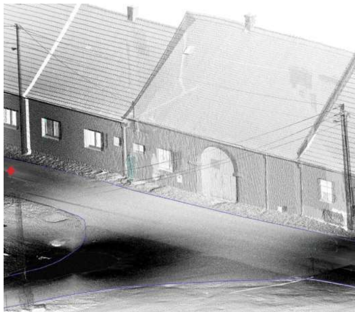
Obrázek 17: Mračno bodů – základní výstup laserového skenování a povinné spojnice kraje vozovky. [2, s. 43]
