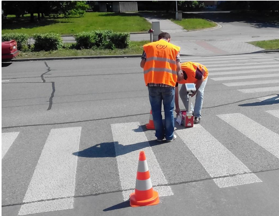
Obrázek 4 - Provádění měření retroreflexe VDZ v terénu
