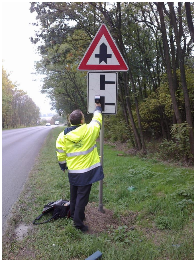
Obrázek 3 - Provádění měření retroreflexe SDZ v terénu
