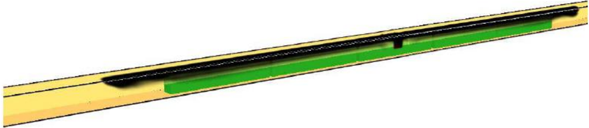
Obr. 17: Šíření kouře při hoření vagonu osobního vlaku v čase 2 min
