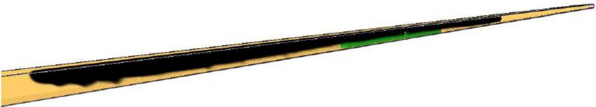
Obr. 18: Šíření kouře při hoření vagonu osobního vlaku v čase 5 min
