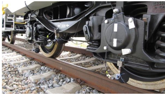
Obr. 36: Umístění mikrofونů na podvozku – vnitřní hluk
