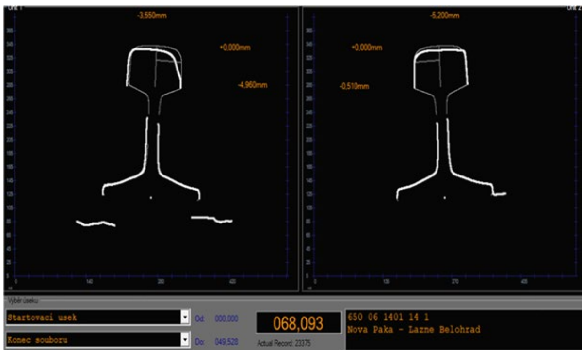
Obrázek 2: Ukázka dat příčného profilu kolejnice (zdroj: CTD SŽ)
