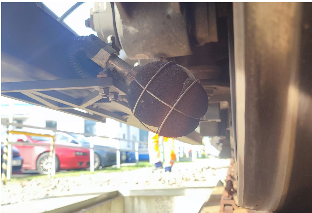
Obrázek 10: Ukázka umístění mikrofonu v blízkosti styku kola a kolejnice
